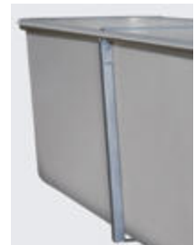
Großbehälter: Innenstreben aus Edelstahl für den Einbau ins Erdreich, Außenstreben feuerverzinkt für die oberirdische Aufstellung
