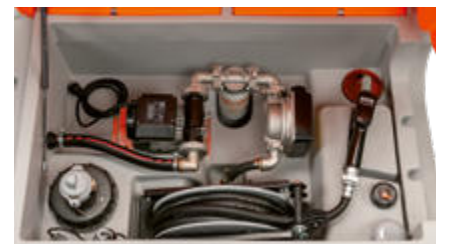
Outdoor Premium Zähler K33, Filter mit Wasserabscheider, Schlauchaufroller mit 8 m Schlauch DN19, mit Klappdeckel
