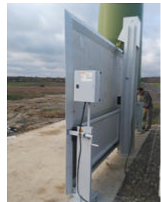
Schutzkasten für Steuerbirne bei der Ausführung mit Elektrokettenzug
