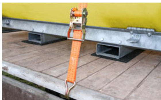
Ladungssicherung mit Antirutschmatte und Zurrgurten (Niederzurren) am Beispiel eines Mobilien Bewässerungssystems 2.000 Liter
