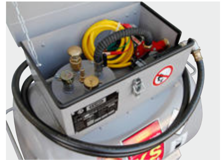
Pumpenkasten (KS-Mobil 200I) mit Elektropumpe 12 V, 25 l/min, ATEX, 4 m Abgabeschlauch und Automatik-Zapfpistole
