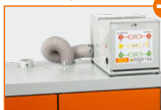
Auflast-Prüfung für Ventilator
