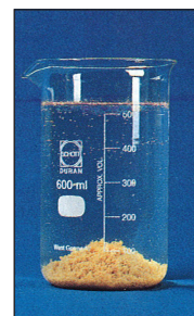
Abb. 6 Klares Wasser mit abgesetzten Flocken
