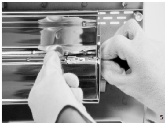
5. QUITAR LAS DOS CÁPSULAS ELASTOTÉRMICAS QUE CUBREN EL FINAL DE LA BOMBILLA Y DESCONECTAR LOS DOS FASTON QUE UNEN LOS CABLES A LA BOMBILLA. (SI LAS CÁPSULAS UTILIZADAS RESULTAN GASTADAS, ESTAS DEBEN SER QUITADAS CORTANDO LOS CABLES JUNTO A LOS DOS FASTON)
