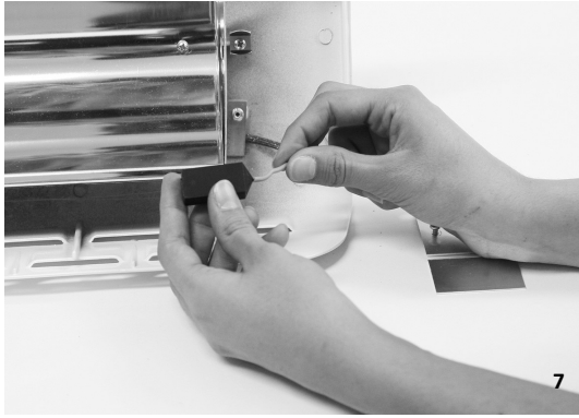
7. DÉNUDER LES FILS SUR 5/6 MM
