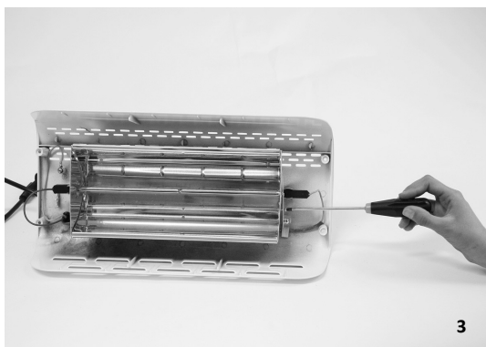
3. SVITARE LE VITI CHE TENGONO LE DUE PICCOLE PROTEZIONI LATERALI.
