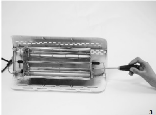
3. DESATORNILLAR LOS TORNILLOS QUE SOSTIENEN LAS DOS PEQUEÑAS PROTECCIONES LATERALES.
