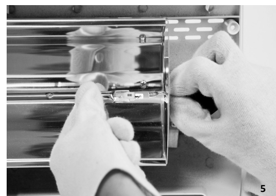
5. SFILARE LE DUE CAPSULE ELASTOTERMICHE CHE COPRONO LA FINE DEL BULBO E DISCONNETTERE I DUE FASTON CHE UNISCONO I CAVI AL BULBO. (SE LE CAPSULE UTILIZZATE RISULTANO USURATE, QUESTE DEVONO ESSERE RIMOSSE TAGLIANDO I CAVI ACCANTO AI DUE FASTON)
