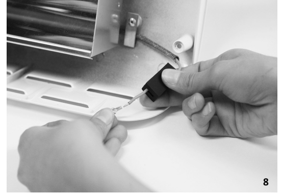
8. INSTALAR LOS NUEVOS FASTON DE REPUESTO Y APRETARLOS EN LA PARTE PELADA DE LOS CABLES PRESTAR ATENCIÓN A NO TOCAR LA BOMBILLA CON LAS MANOS DESNUDAS.
