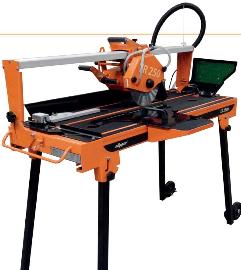
Wertige und besonders robuste Fliesenschneidmaschine. Durch den langen Auflagetisch ist das Schneiden von Fliesen und ähnlichen Produkten bis 1000 mm Länge problemlos möglich.
