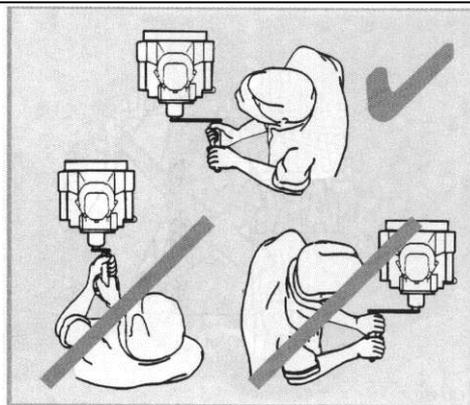
Drehen Sie nach dem Einrasten der Dekompressionsautomatik am Anschlag fünf Mal den Handkurbel um, bis der Motor wieder komprimieren und zünden kann.
