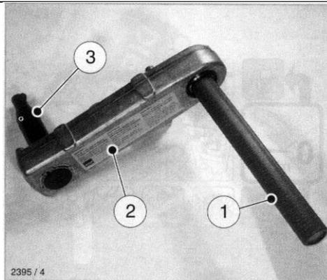
Der Kraftschluß zwischen Motor und Andrehkurbel muß durch verdrehsicheres Festhalten des Griffrohrs und zügiges Drehen gewährleistet sein und darf während des Startvorganges unter keinen Umständen unterbrochen werden.
