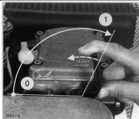
Bringen Sie den Drehzahlverstellhebel 1 nach Bedarf in START oder ½-START. Vergewissern Sie sich, daß der Stop-Hebel auf der rechten Seite der Maschine nicht auf STOP steht, sondern ganz entgegengesetzt ist.
