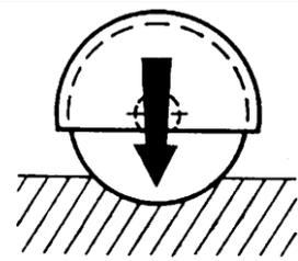
Öffnen Sie das Absenkventil (bei hydraulischer Maschine) oder drehen Sie die Kurbel (bei handgetriebener Maschine) in der angezeigten Richtung um das Blatt zu senken.
