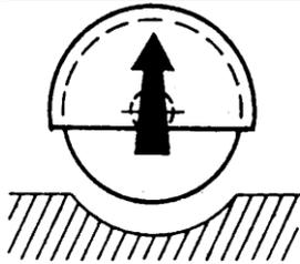
Pumpen Sie (bei hydraulischer Maschine) oder drehen Sie die Kurbel (bei handgetriebener Maschine) in der angezeigten Richtung um das Blatt anzuheben
